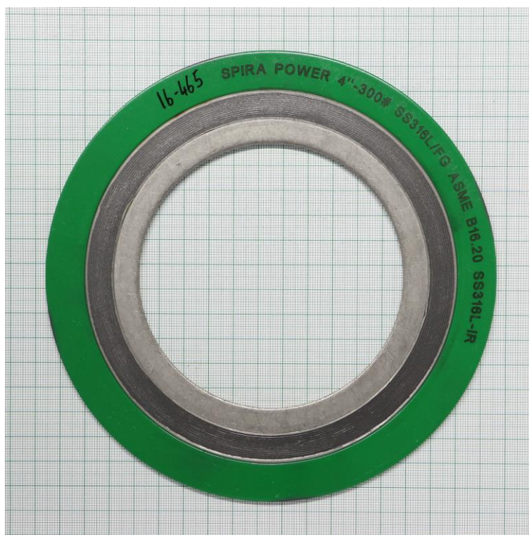
Creep relaxation test at 120 MPa - RT (EN 13555)
