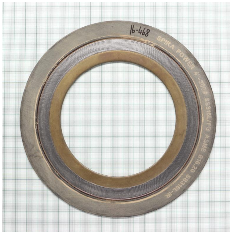
Compression test at 400 °C (EN 13555)
