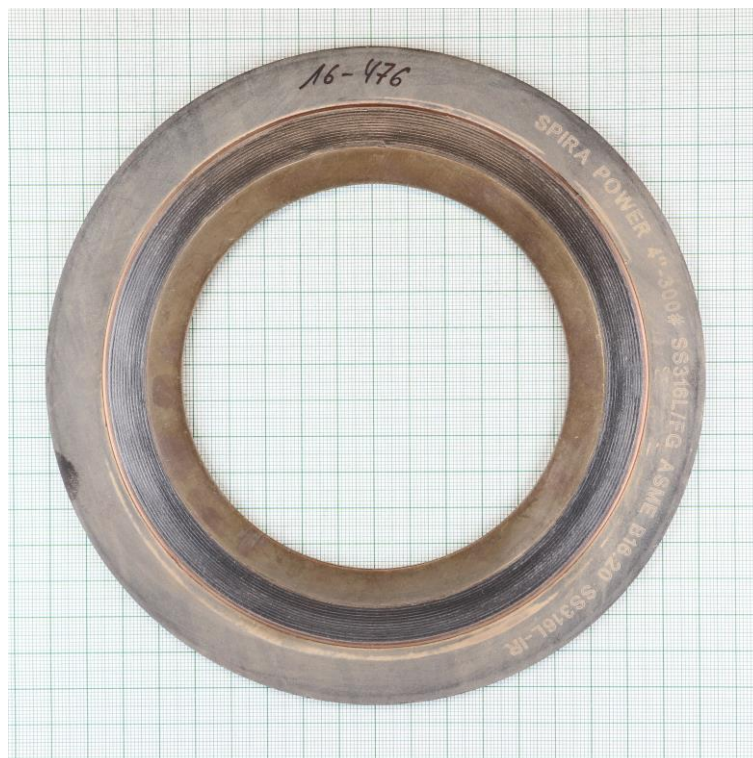
Compression test at 400 °C (EN 13555)
