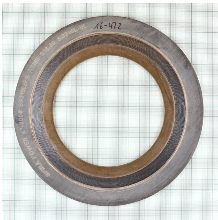
Creep relaxation test at 120 MPa - 400 °C (EN 13555)
