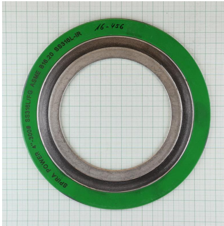
Compression test at RT (EN 13555)
