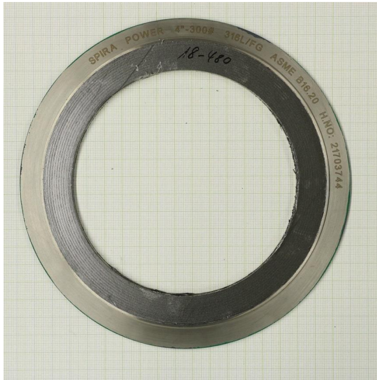
Creep relaxation test at 80 MPa - RT (EN 13555)
