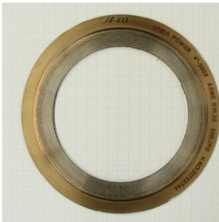
Creep relaxation test at 80 MPa - 400 °C (EN 13555)
